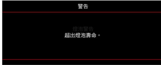
出現此訊息時，請聯絡您當地經銷商或服務中心以儘速更換燈泡。在更換燈泡之前，請確定關閉投影機、拔除電源線，並確定投影機冷卻至少 30 分鐘且燈泡已完全冷卻。
