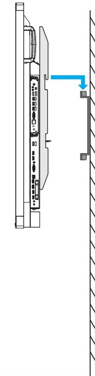
5. Sichern Sie die dualen Montagehalterungen und die Wandhalterung mit zwei Schrauben (C).
