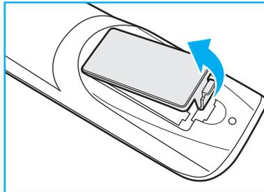
2. Legen Sie zwei Batterien mit der richtigen Polarität (+/-) entsprechend der Kennzeichnung im Batteriefach ein.
