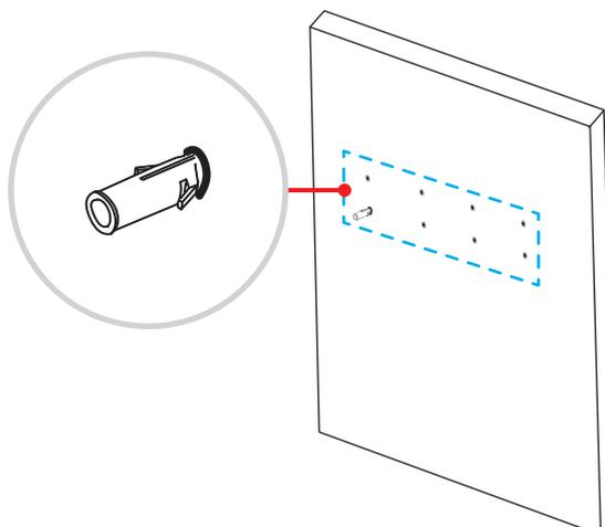
3. Positionieren Sie die Wandhalterung an der Wand. Sichern Sie dann die Wandhalterung mit acht Schrauben (**B**) über die Unterlegscheiben in den in der Wand installierten Dübeln.
