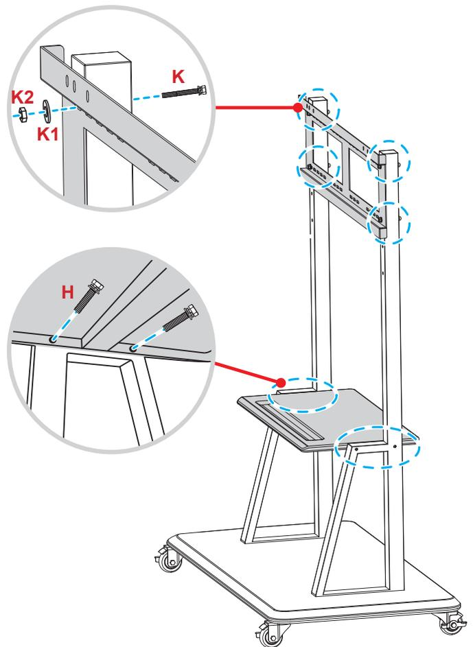
7. Richten Sie die dualen Montagehalterungen an der an den Ständerstangen montierten Wandhalterung aus und haken Sie sie ein.
