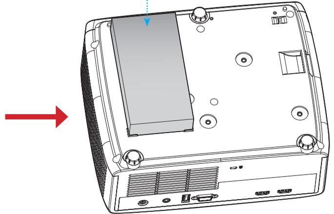
2. Kencangkan adaptor AC dengan pengikat kabel.
