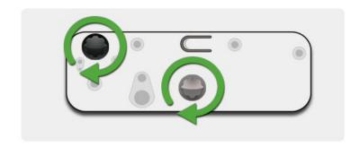
4. Ruotare la manopola grigia in senso antiorario finché i fasci non si trovano simmetricamente sullo stesso livello.
