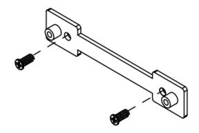
Usare viti per il fissaggio della staffa di TouchBeam sulla lavagna:
