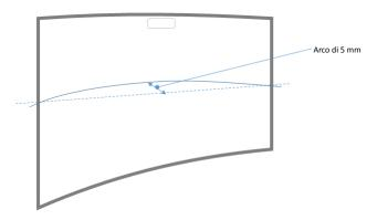
Se la superficie di proiezione soddisfa i criteri precedenti, è possibile installare il proiettore e il modulo TouchBeam in uno dei seguenti modi:
