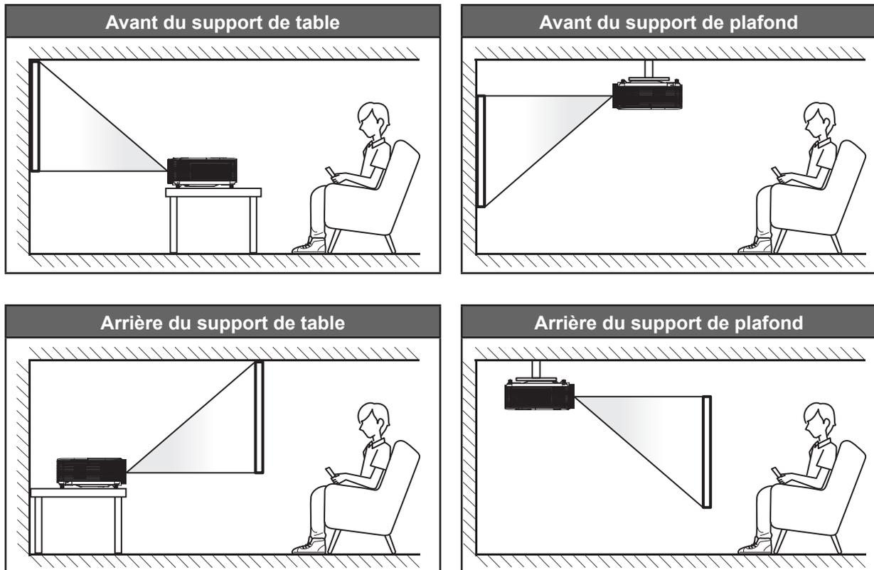
Le projecteur doit être placé à plat sur une surface plane et à 90 degrés/à la perpendiculaire de l'écran.
