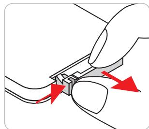
2. 새 배터리를 함체에 설치합니다. 사용한 배터리를 제거하고 새 배터리를 설치합니다(CR2025). "+"가 있는 면이 위로 향하도록 합니다.
